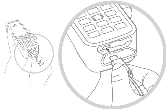
将充电器连接到电源，然后将 Micro USB 插头连接到电话底部、USB／音频保护盖下方的充电插口。
