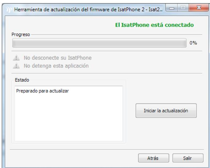
Conecte el IsatPhone 2 al ordenador mediante el cable USB que se suministra con el teléfono. Verifique que el teléfono esté encendido.
