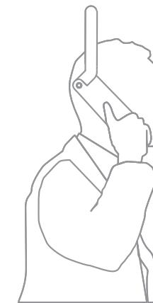
Выберите место на открытом воздухе, откуда хорошо просматривается небо, и направьте антенну телефона вверх. Между антенной и спутником не должно быть препятствий.
