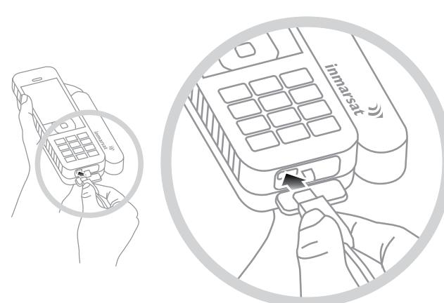
Подключите зарядное устройство к источнику питания, а разъем micro USB – к соответствующему разъему USB/аудио в основании телефона, закрытому защитной заглушкой.
